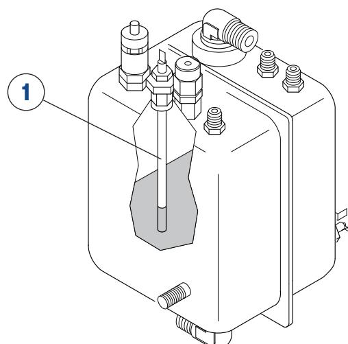
Um ein Überlaufen durch Störungen an der Maschine oder Wasserlecks des Kreislaufs zu verhindern, ist die elektronische Steuerung mit der Vorrichtung "Time-out" ausgerüstet, d.h. die Unterbrechung des automatischen Wassereintrags nach einer Höchstzeit von 120 Sekunden.
